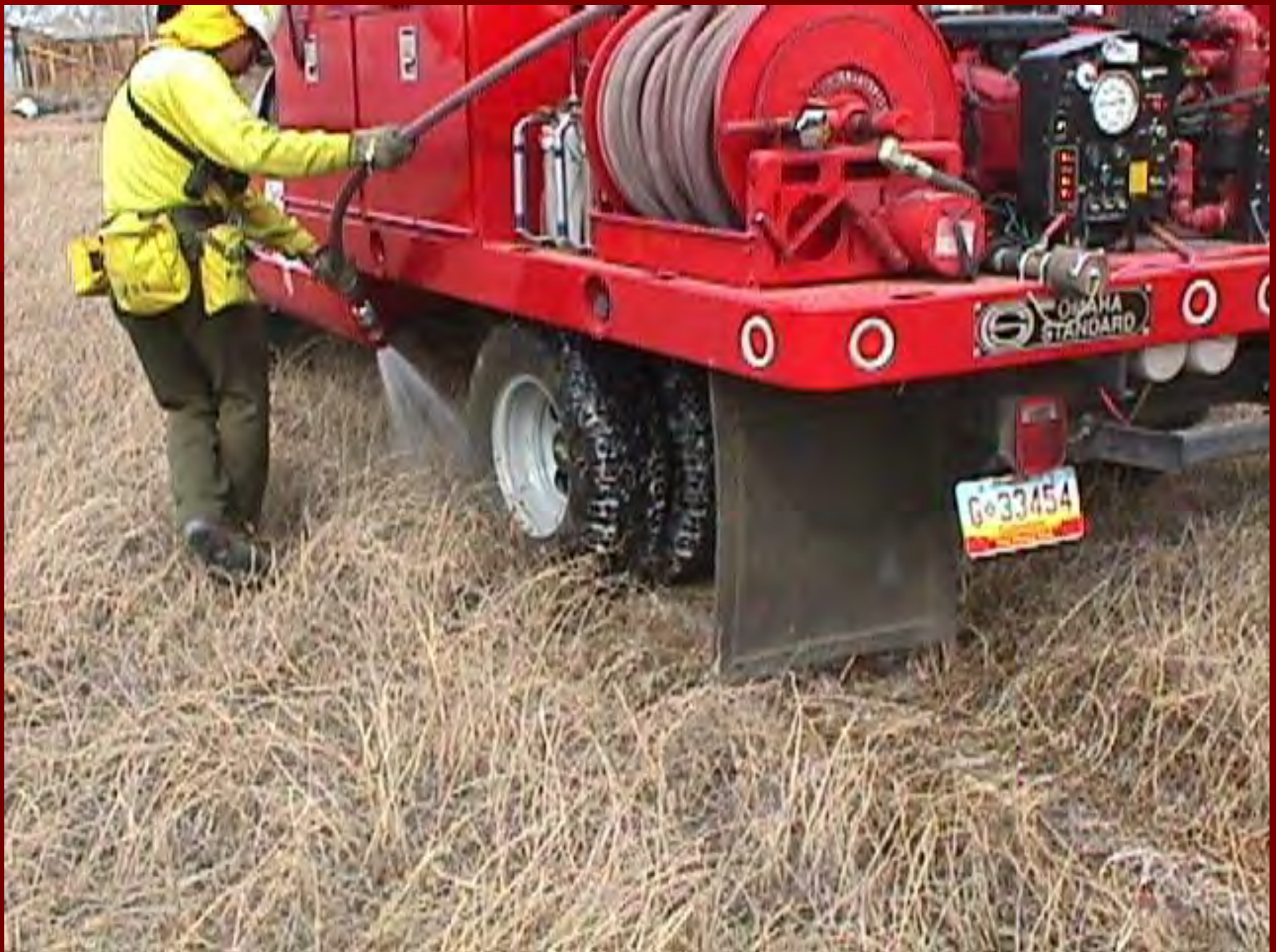
Spraying down a wet line / linijos supurškimas vandeniu
