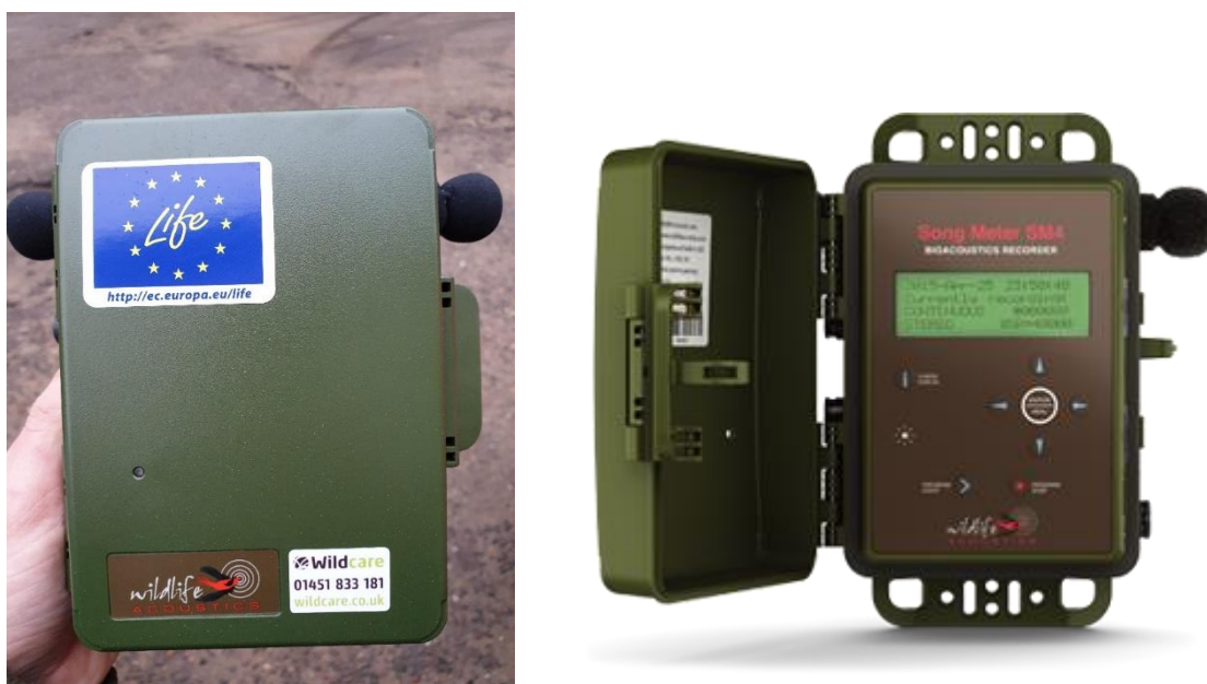
3.2 pav. Song meter SM 4 Acoustic Recorder prietaisas paruoštas darbui (kairėje) ir vidinis prietaiso vaizdas (dešinėje)
