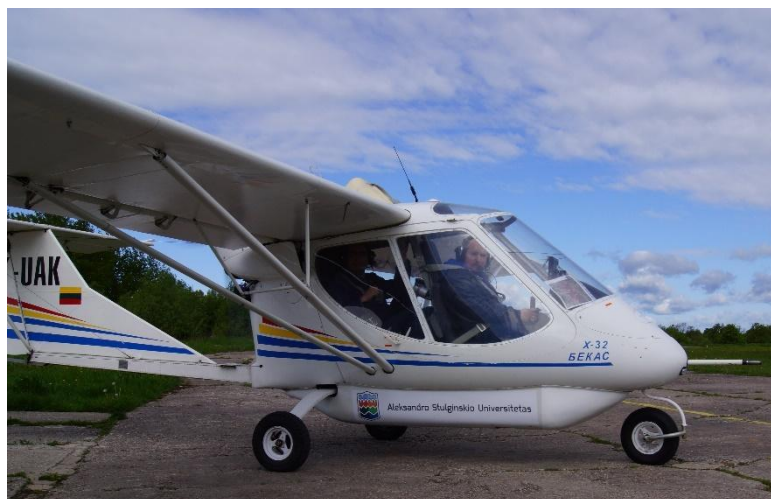
3.7 pav. Ultra-lengvasis orlaivis Bekas x32 pritaikytas aerofotografavimo darbams.
