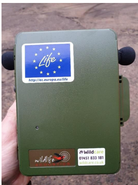
2 pav. Song meter SM 4 Acoustic Recorder prietaisas paruoštas darbui (kairėje) ir vidinis prietaiso vaizdas (dešinėje)
